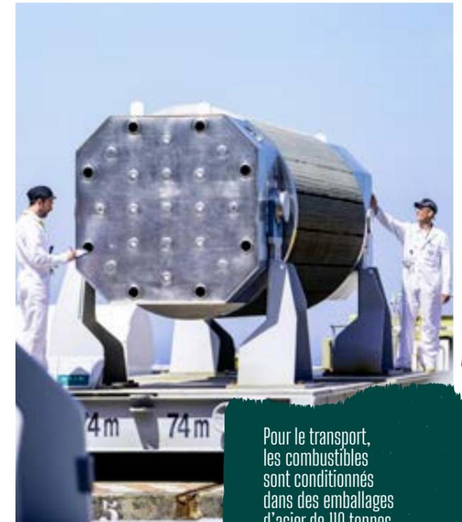
Pour le transport, les combustibles sont conditionnés dans des emballages d'acier de 110 tonnes (pour 6 tonnes de matières nucléaires), qui permettent de les transporter en toute sûreté et sécurité par route, par voie ferroviaire ou voir maritime..
